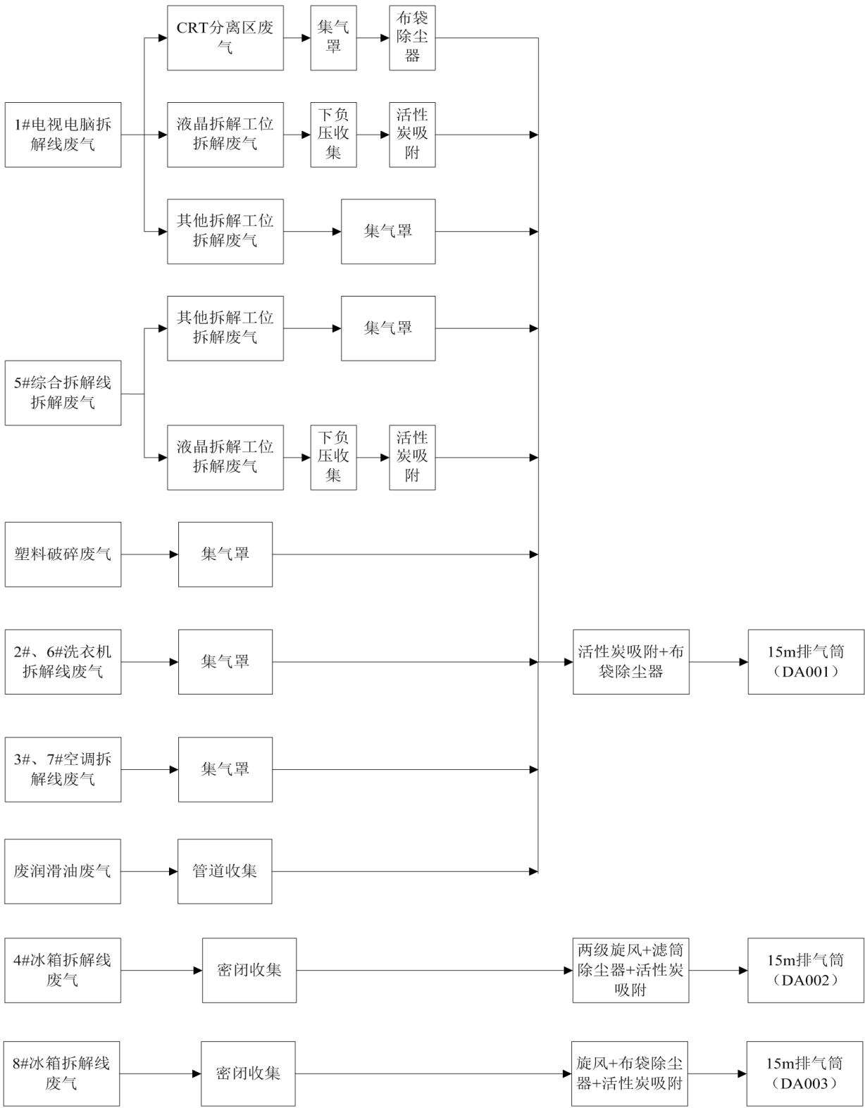
图 5.1-1 本项目废气处理工艺流程图
