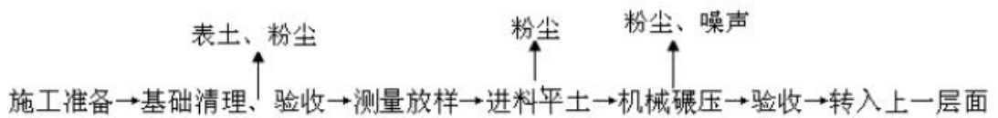
图 2.10-1 路基土石方填筑施工工艺图
