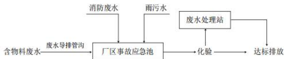
图 6.8-1 项目事故废水收集系统
