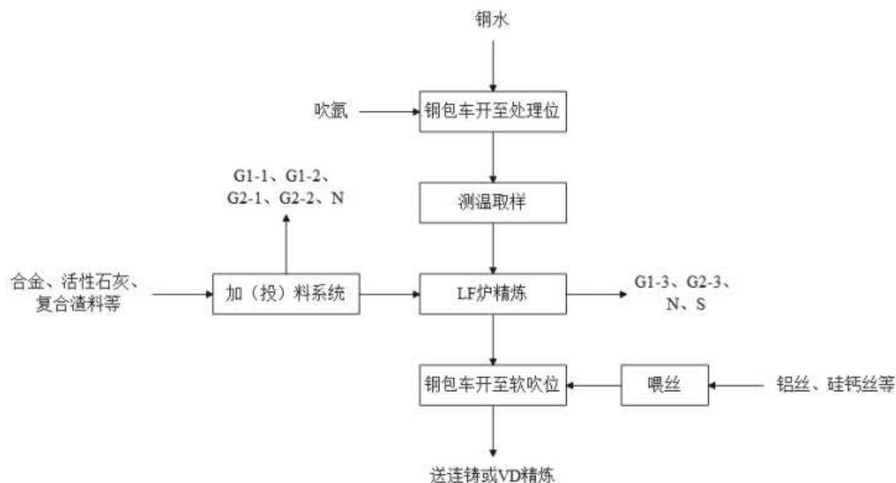
图 3.2-4 项目精炼工艺流程及产污环节图
