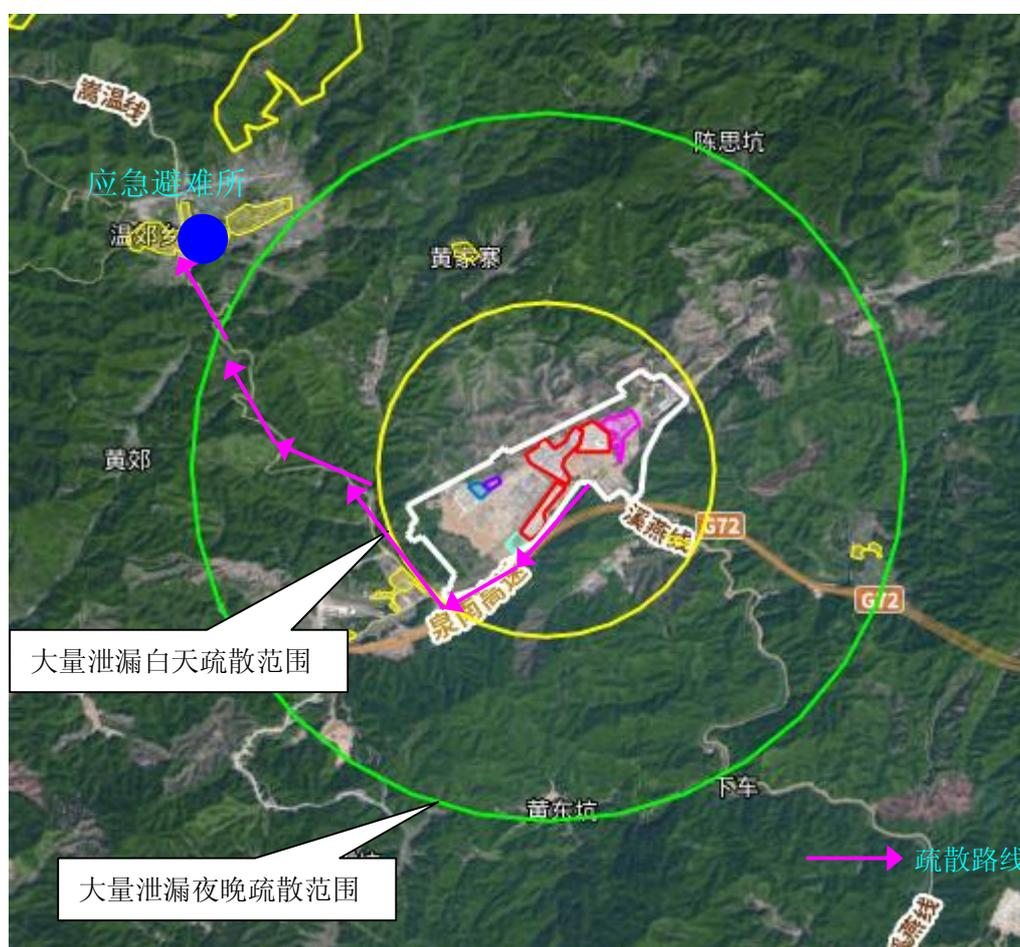
图 6.8-5 按《无水氟化氢泄漏的处理处置方法》（HG/T4685-2014）确定 HF 泄漏撤离范围分布示意图
