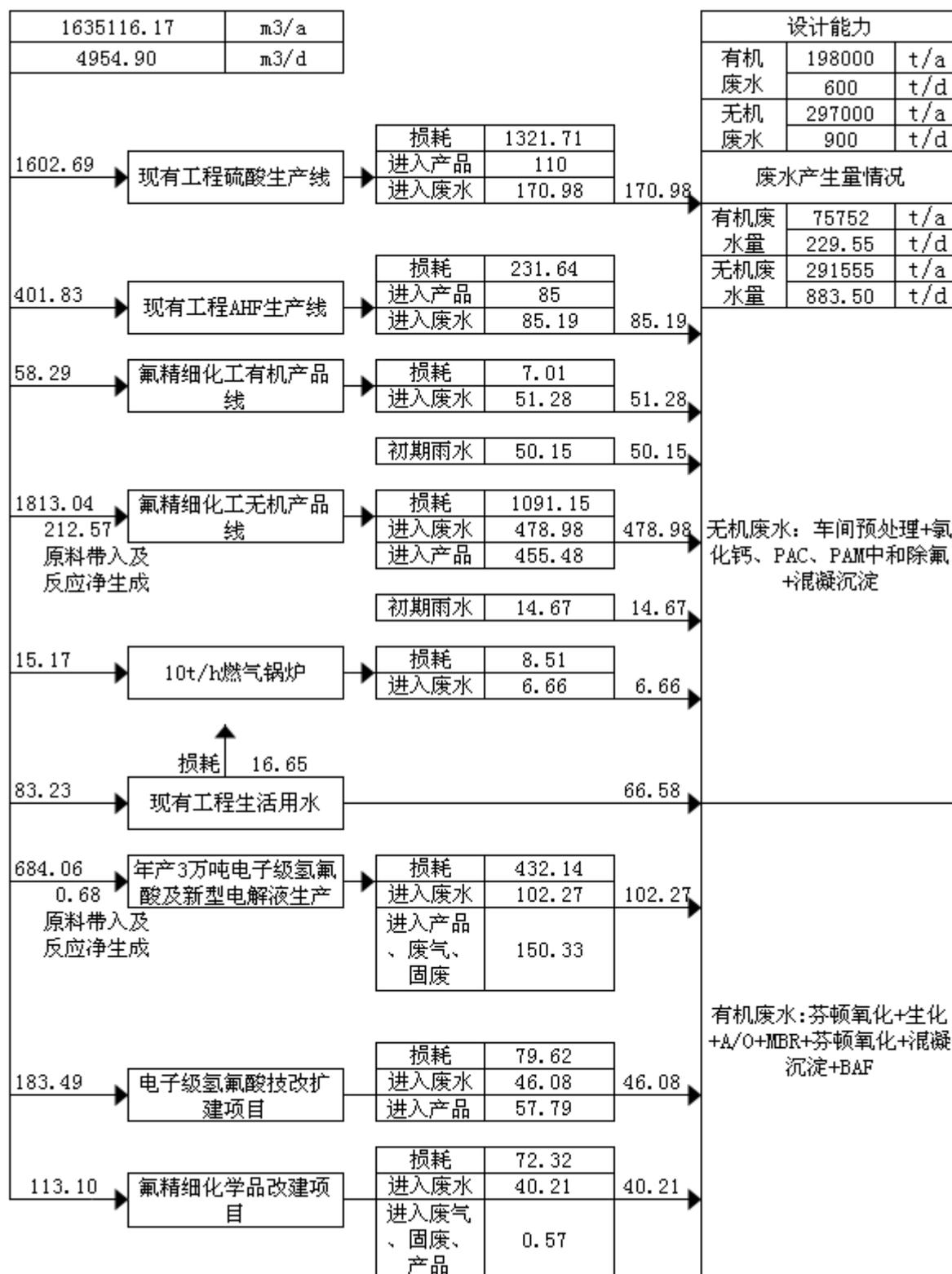
图 3.4-2 改扩建后全厂水平衡图 单位：t/d（已标注的除外）
