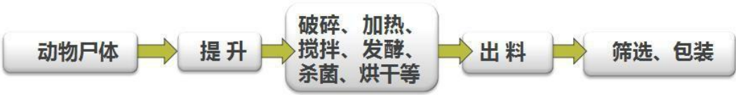
图 3.2-3 动物尸体无害化处理工艺流程
