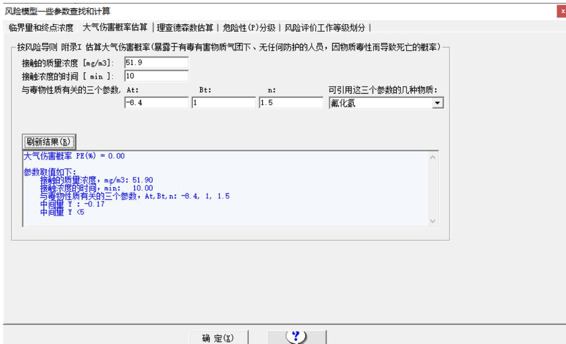
图 8.7-11 氟化氢泄漏伤害概率计算结果截图
