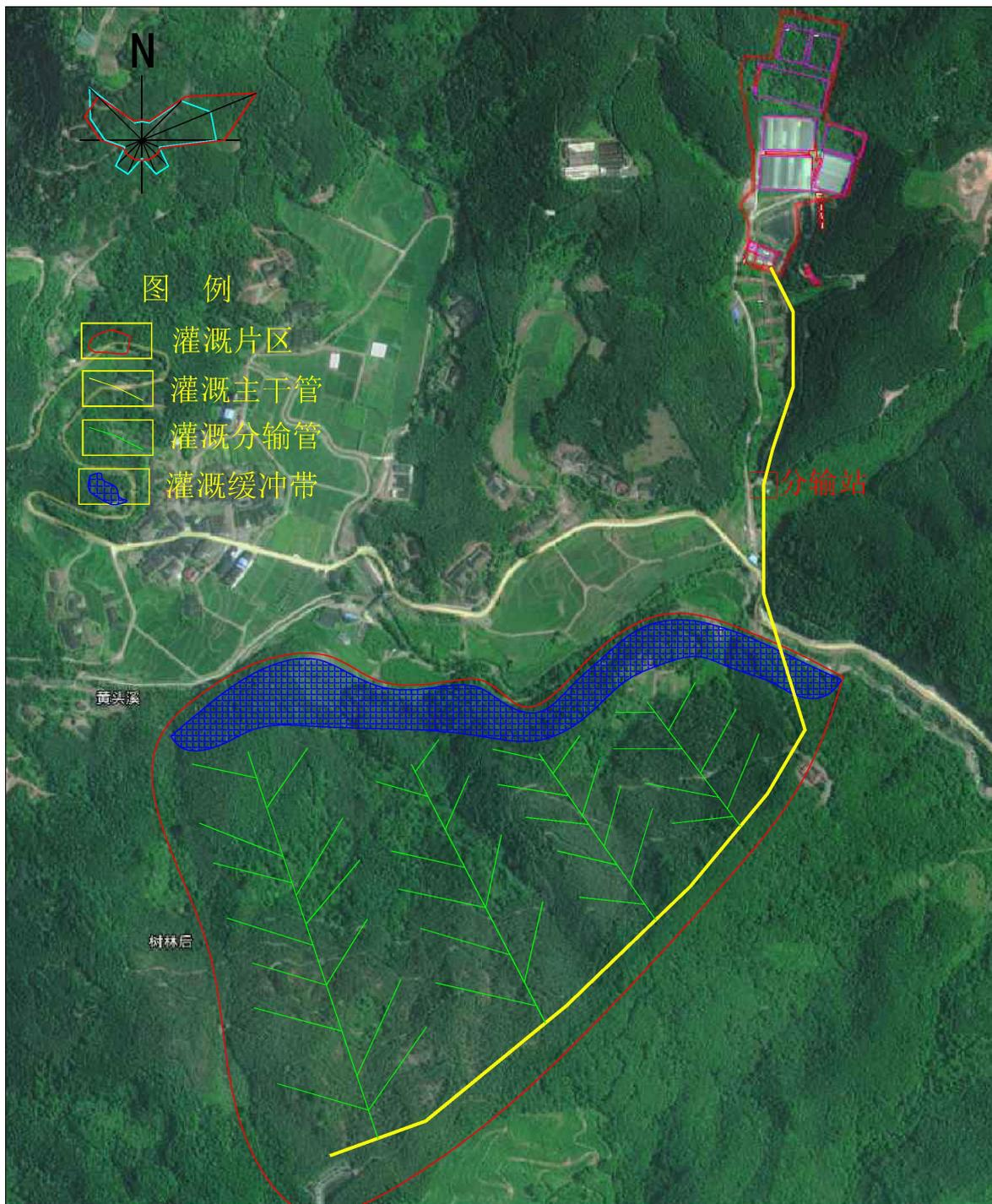
图 5.1-5 废水灌溉区分布、缓冲带及输送管线图
