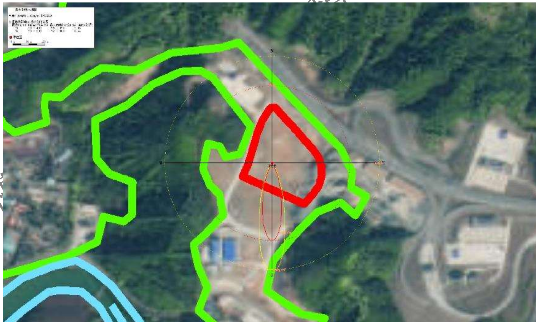
图 6.7-4 最常见气象条件下，氢氟酸储罐泄漏事故最大影响范围图
